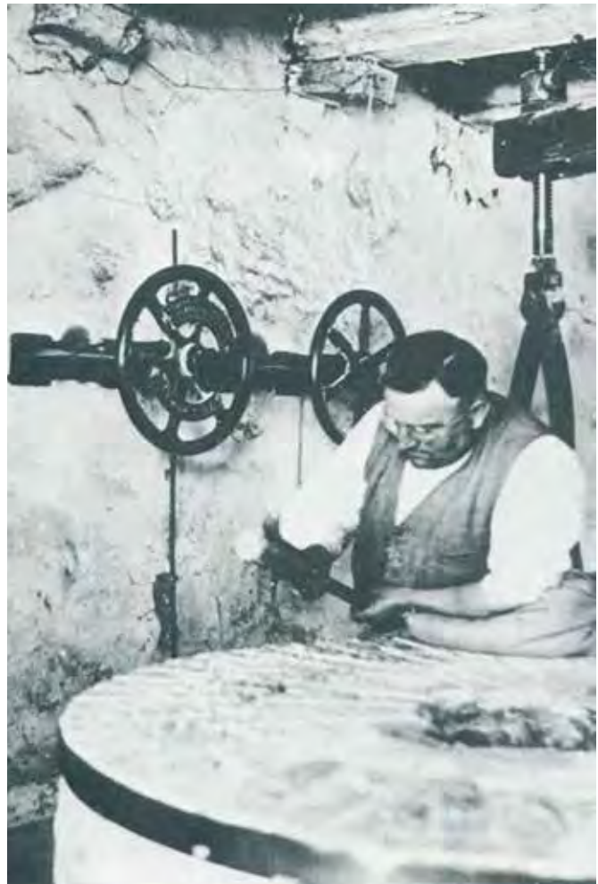
Der Schrassiger Müller Michel Altmann beim Behauen eines Mühlsteins
