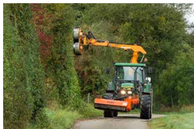
Wege schnitt: Der Schneidkopf (Skorpion) wird an einen Traktor angebaut und kann drei Arbeitsgänge gleichzeitig erledigen: Schnitt, Häckseln, Räumen.
