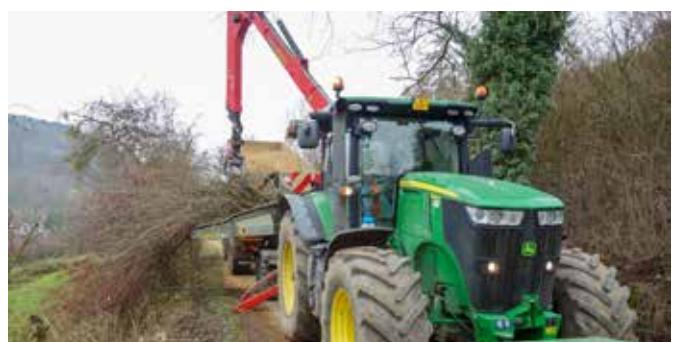
Weiterverarbeitung: Häckseln des Schnittguts. Dieses wird später als Mulchmaterial eingesetzt oder thermisch verwertet.
