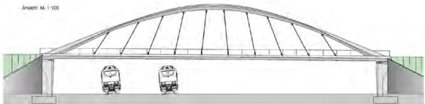
De plus, la section variable de l'arc, l'inclinaison des arcs vers l'intérieur et la section des poutres latérales confèrent un aspect dynamique à l'ouvrage accompagné d'une valeur architecturale élevée.
